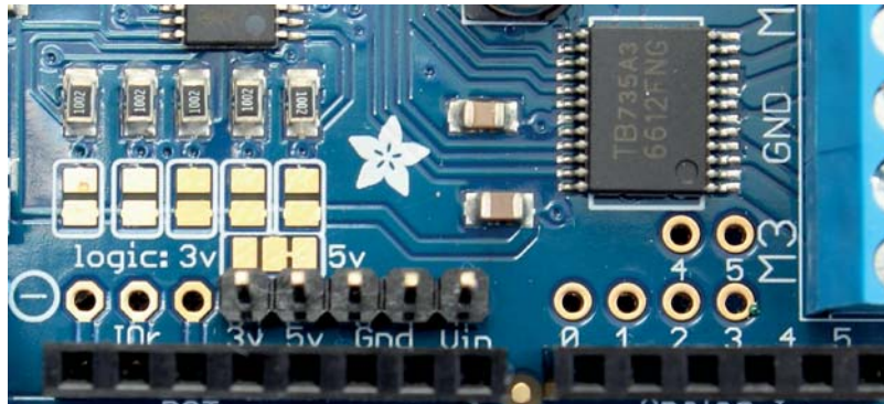
Abb. 3–19 Zusätzliche Pinheader für 3,3V, 5V, 2xGND und Vin (9V)
