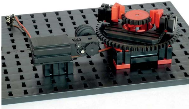
Abb. 6-13 Der ein- und auskoppelbare Antrieb des Gelenks
