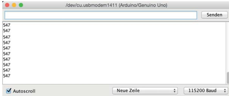
Abb. 6–18 Die gemessenen Potenziometerwerte werden auf dem seriellen Monitor angezeigt.
