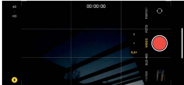
Abbildung 3.26: Bei sehr dunklen Szenen aktiviert die Kamera-App ein LED-Licht. Sie können das Licht über das Blitz-Symbol deaktivieren. Möchten Sie das LED-Licht bei hellerer Umgebung verwenden, dann hilft dieser Trick: Halten Sie die Hand vor die Kamera, bis das Blitz-Symbol gelb leuchtet. Starten Sie die Videoaufnahme, und nehmen Sie die Hand von der Kamera. Wollen Sie beispielsweise Motive in kurzer Distanz bei Gegenlicht aufnehmen, kann das LED-Licht helfen.
