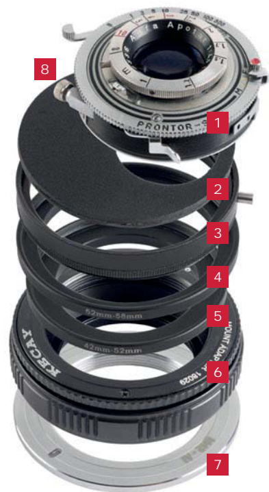
Aufbau des drehbaren Shift-Objektivs von oben nach unten: (1) Objektiv, (2) Befestigungsplatte, (3) drehbarer Filterhalter, (4) Filteradapter 52 auf 58 mm, (5) Filteradapter 42 auf 52 mm, (6) Helicoid, (7) Adapter M42 auf Kamerabajonett, (8) Schraube zur Fixierung des Verschlusses
