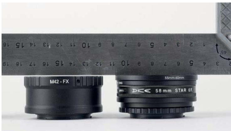
Ein Adapter von M42 auf Fujifilm-X dient als Maßstab für den Shift-Adapter. Hier muss der oberste Filteradapterring noch etwas abgeschliffen werden.
