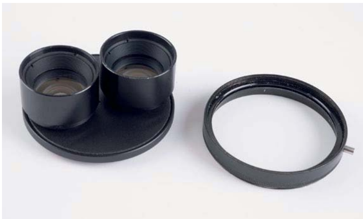
Die beiden Objektivstämme werden in die Grundplatte eingeklebt, die wiederum in einen Filteradapter und dann komplett in eine drehbare Filterfassung eingesetzt wird.
