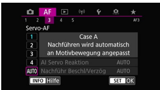
Abb. 3.4 Das dritte Register des violetten Autofokus-Menüs zeigt die fünf Cases. Vier davon können Sie nach Ihren Präferenzen anpassen.
