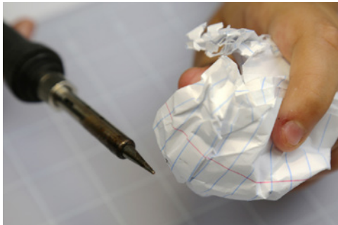
Abbildung 3–26. Eine Möglichkeit, die Spitze eines LötKolbens zu reinigen. Bewege das zerknüllte Papier schnell, damit es nicht verkohlt.
