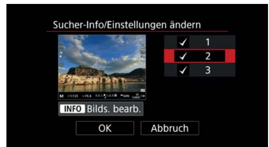
Abb. 1.34 Für den Sucher stehen drei Anzeige-Varianten zur Verfügung, die Sie über die Taste »Info« wechseln können.
