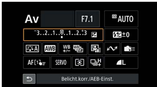
Abb. 1.36 Sobald Sie die Taste »Q« drücken, erscheint ein orangefarbiger Rahmen auf dem Schnelleinstell-Bildschirm. Die eingerahmte Funktion können Sie nun mit den Bedienelementen einstellen. Sie können aber auch einfach auf das Display tippen (wie bei Ihrem Smartphone).
