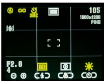
Das LCD-Display dieser Kompaktkamera zeigt alle notwendigen Einstellungen für die Astrofotografie (hier gelb markiert): abgeschalteter Blitz; Scharfeinstellung auf Unendlich (∞-Symbol); Selbstauslöser (für diese Kamera gibt es keinen Fernauslöser); manuelle Belichtung (M); Weißabgleich »Tageslicht« (Sonnensymbol).
