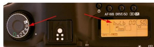
Bei DSLs ist die Langzeitbelichtung (über 30 s) über die Einstellung B oder »Bulb« verfügbar.
