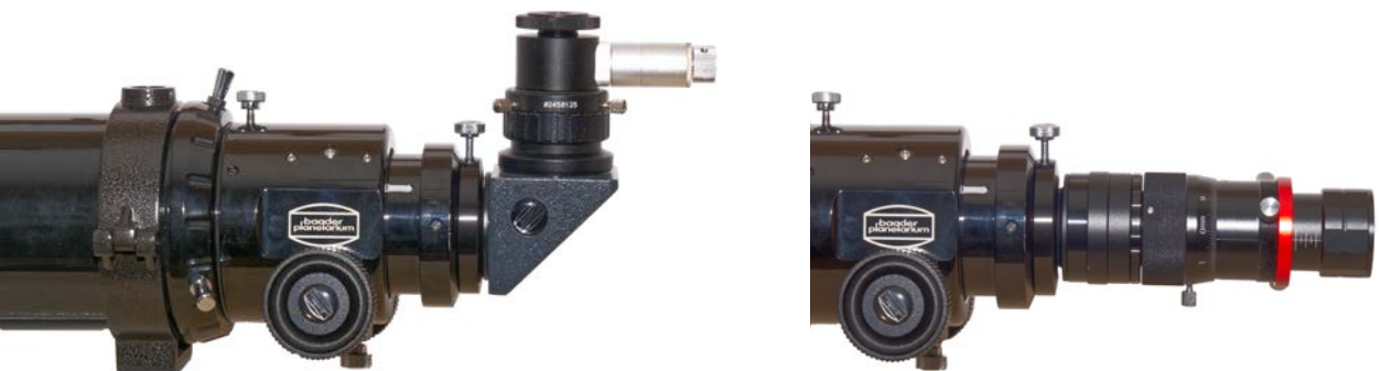
Kamera und Okular haben unterschiedliche Fokuslagen. Links ein Fadenkreuzokular mit Zenitspiegel, um den Planeten zu zentrieren, rechts eine Planetenkamera mit diversen Verlängerungshülsen und einem Helikalfokussierer, damit ohne Nachfokussieren zwischen Okular und Kamera gewechselt werden kann. Der Kamerasensor befindet sich etwa auf derselben Höhe wie der rote Feststellring.
