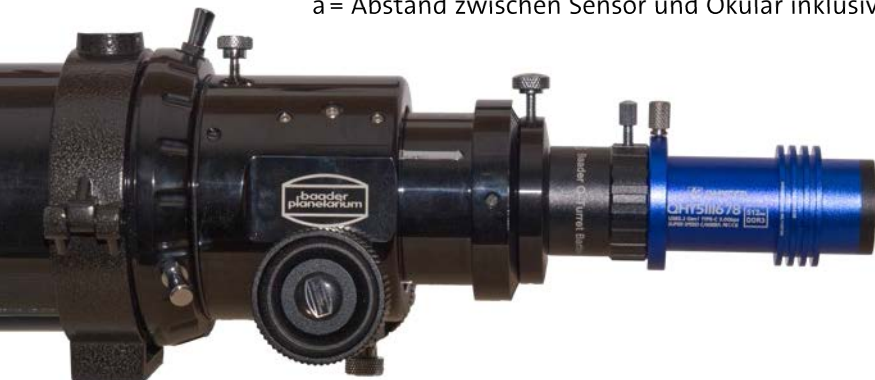
Ein Videomodul mit Barlowlinse im Okularauszug
