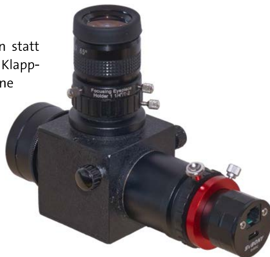
Mit einem Klappspiegel kann zwischen Okular und Kamera umgeschaltet werden. Der rote Feststellring bringt die Kamera in den selben Fokus wie das Okular.
