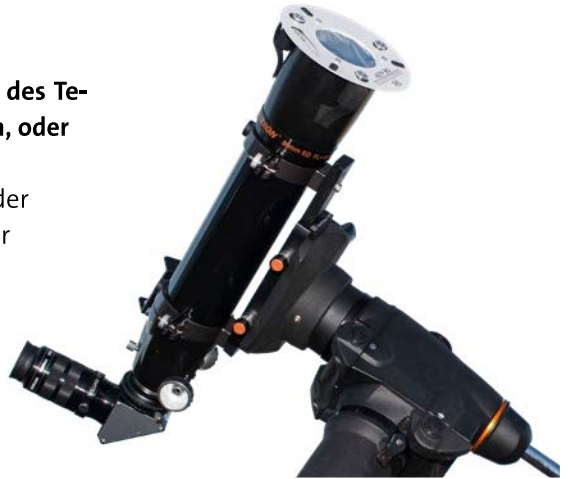
Ein Folien-Sonnenfilter vor dem Objektiv bietet Schutz. Die ASTF-Filterfassungen von Baader Planetarium sind temperaturkompensierend, damit die Folie auch bei langen Beobachtungszeiten nicht unter Spannung gerät und der Kontrast nicht einbricht.
