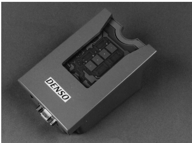
Abb. 3.29 Halb geöffnetes Lesegerät für Close-coupling-Chipkarten nach ISO/IEC 10536. In der Mitte des Einsteckschlitzes sind vier kapazitive Koppelflächen zu erkennen, umgeben von vier induktiven Koppelementen (Spulen). (Foto: Denso Corporation, Japan – Aichi-ken)
