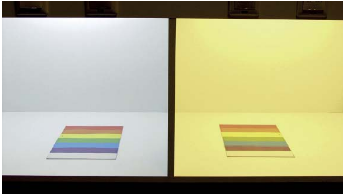
Bild 2.9 Verschiedene Lichtfarben in einem Farbarmaturkasten: linker Kasten 6500 K (Tageslichtweiß), rechter Kasten 2700 K (Warmweiß)
