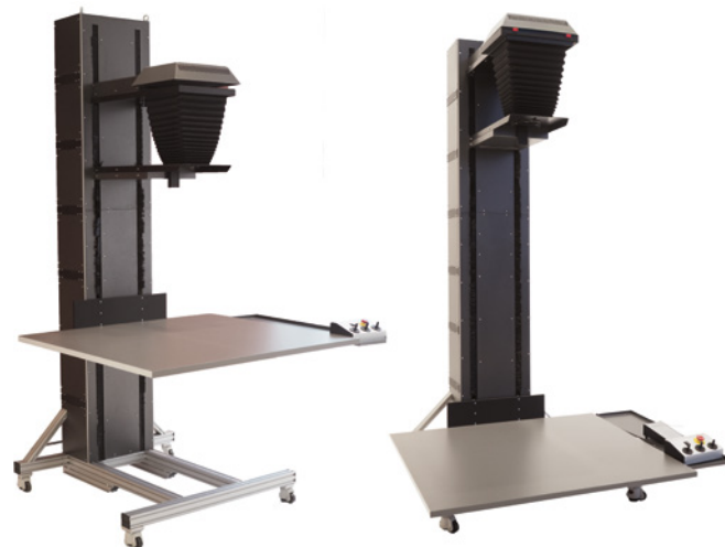
Abbildung 1.9: Neues 8x10 Inch Vergrößerungssystem für Negative bis 8x10 inch von Heiland electronic mit motorischer Steuerung für die Einstellhöhe des Vergrößerungskopfs, der Grundplatte sowie der Schärfereinstellung Die Lichtquelle ist eine Heiland-LED-Kaltlichtquelle, nutzbar für Schwarz-Weiß-Multigrade, Splitgrade-Printing und auch Farbvergrößerungen.
