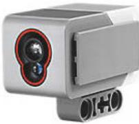
Abb. 1.4: Der LEGO-Colorsensor
