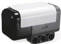
Abb. 1.7: Der Hitechnic-Kompass-Sensor
