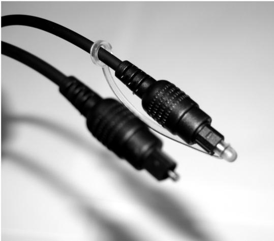
**Abb. 1.23:** TOSLINK-Verbindung – der Lichtwellenleiter
