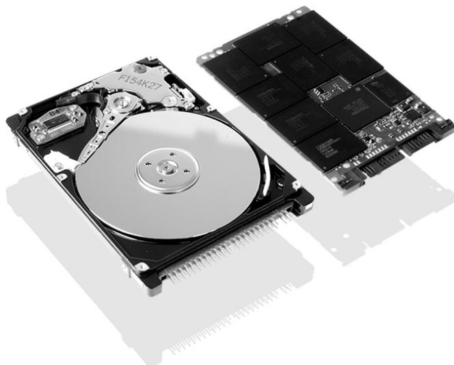
Abb. 1.6: Festplatten – und Solid State Drive (Quelle: [www.sony.com.au](http://www.sony.com.au))
