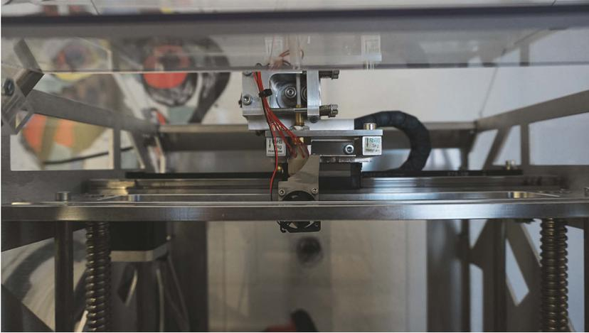
Abb. 2.3: Druckkopf des RF 1000 in einer seitlichen Ansicht
