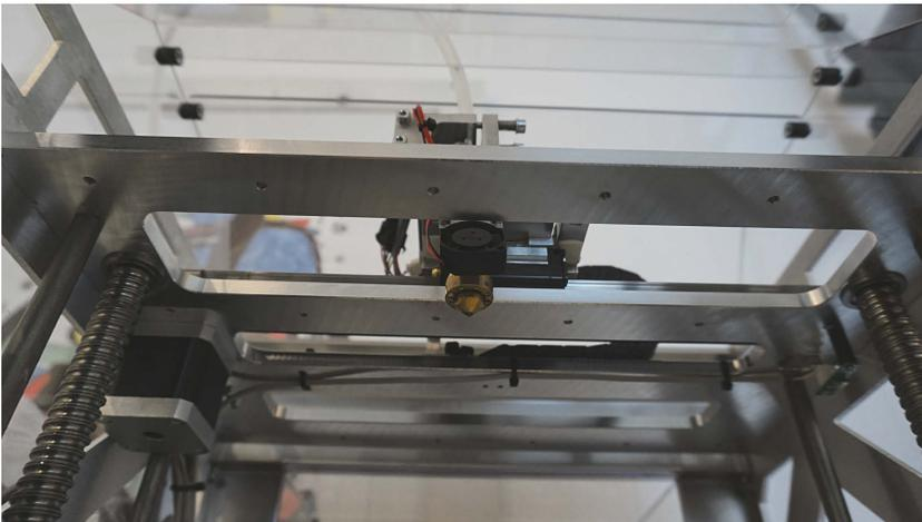
Abb. 2.4: Die Druckdüse (Extruder) des RF 1000
