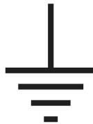
Elektriker nutzen es, um nicht jedes Mal einen 2,5 m langen Kupferstab zeichnen zu müssen. Ein Stromkreis mit einer solchen Verbindung wird als »geerdet« bezeichnet.
