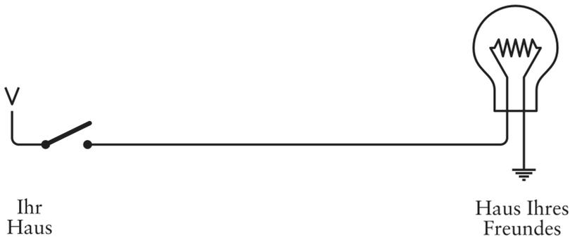
Das V steht für *Spannung*, könnte aber in gewisser Weise auch *Vakuum* bedeuten. Sie können sich das V als Elektronensauger vorstellen und die Erdung als Elektronenmeer. Mit einem Sauger lässt sich ein Vakuum erzeugen. Dieser Elektronensauger saugt die Elektronen aus der Erde durch den Stromkreis, wo sie eine Arbeit verrichten (z.B. eine Glühbirne zum Leuchten bringen).
