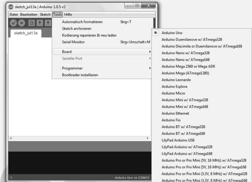
Danach musst du noch den richtigen Port einstellen: Zieh den Arduino Uno ab (falls du ihn bereits angeschlossen hattest), sieh dir unter TOOLS|SERIAL PORT die Ports an und notier sie dir. Danach steckst du den Arduino Uno ein. Den Port, der neu hinzugekommen ist, musst du auswählen. Jetzt kannst du endlich programmieren.
