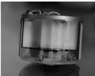
Abb. 1.9: Danalock ohne Batterien – Serienschaltung sichtbar
