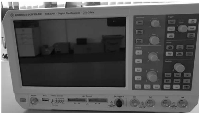
Abb. 1.12: Oszilloskop von ROHDE & SCHWARZ, 4 Kanäle, Mixed-Signal
