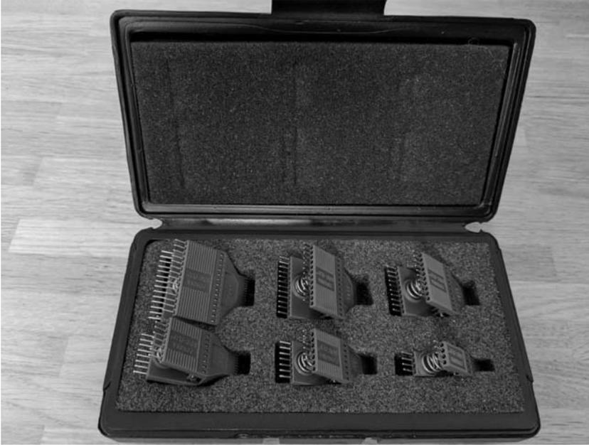
Abb. 1.23: SOIC-Klemmenset – für Ambitionierte
