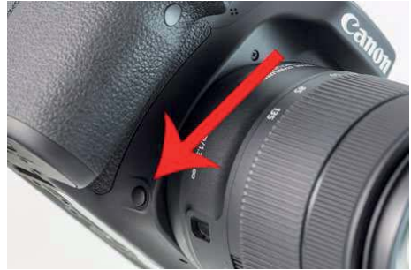
▲ Die Schärfentiefe-Prüftaste sitzt zwischen Handgriff und Objektiv.
