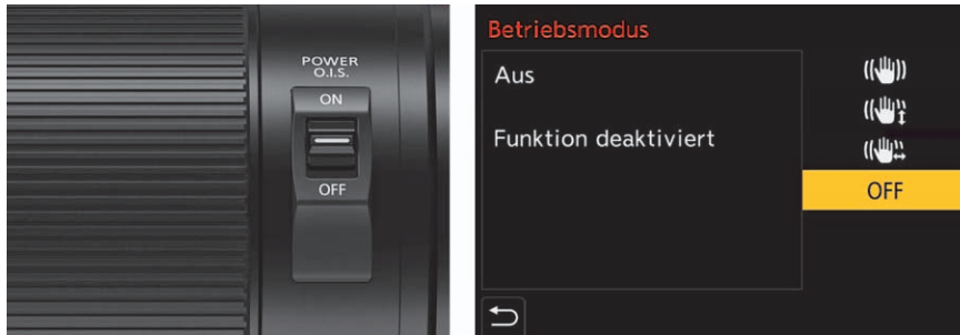
Abbildung 2.11 Links: Sie können den Bildstabilisator mit dem Schalter O.I.S. am Objektiv ein-/ausschalten. Das gilt dann nicht nur für das Objektiv, sondern auch für die Kamera. Rechts: Bei Objektiven mit OIS-Funktion, aber ohne O.I.S.-Schalter (de-)aktivieren Sie die Bildstabilisierung im Kameramenü.
