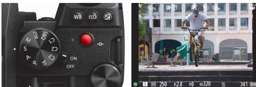
Abbildung 2.8 Das Moduswahlrad steht auf S , wodurch Sie die Zeitpriorität verwenden, wie Sie am S links unten im Sucher oder auf dem Display erkennen. (linkes Bild: Panasonic)
