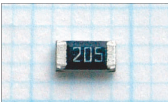
Abbildung 3.3 SMD-Widerstand (Quelle: Haragayato, CC BY-SA 3.0, https://commons.wikimedia.org/w/index.php?curid=199075 )
