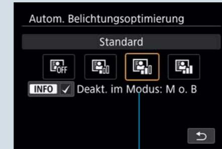
Abbildung 4.18 Hier sehen Sie die Auswahlmöglichkeiten für die **Automatische Belichtungsoptimierung**.
