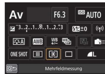
Abbildung 4.33 Auswahl der Belichtungsmessmethode am Monitor
