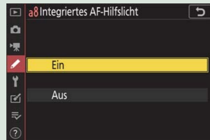
Abbildung 2.6 Um bei Dunkelheit das Motiv zum Fokussieren zu beleuchten, hat die Nikon Z 50 ein integriertes AF-Hilfslicht. In der Individualfunktion a8 Integriertes AF-Hilfslicht können Sie es deaktivieren.
