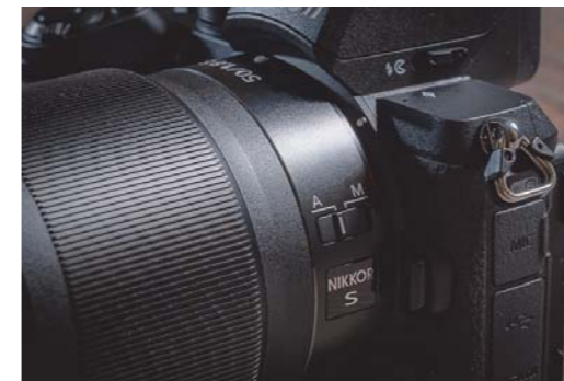
Abbildung 2.30 Die meisten Objektive der Nikkor S-Line verfügen über einen Schalter zum Umstellen vom Autofokus auf die manuelle Fokussierung
