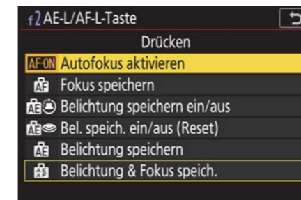
Abbildung 2.14 Die AF-ON-Funktion können Sie auf die AE-L/AF-L-Taste oder auf eine Fn-Taste legen.
