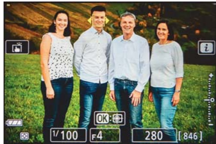
Abbildung 2.19 Die gelben Pfeile zeigen an, dass die Kamera mehrere Gesichter erkannt hat.
