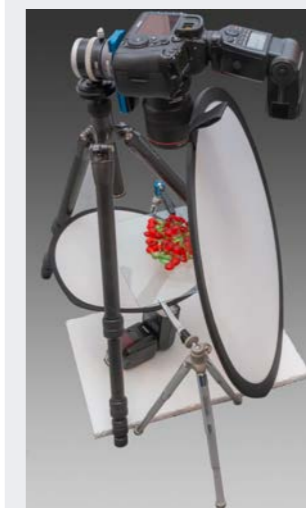
⤴ Durchlichtaufbau mit entfesseltem Blitz und Masterblitz – jeweils per Diffusor abgedämpft
