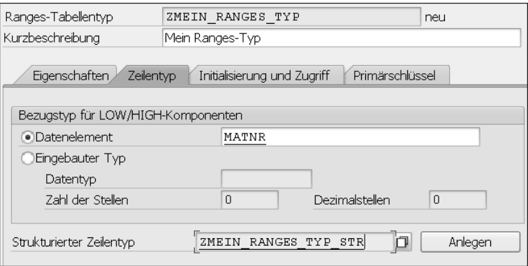
Abbildung 3.15 Anlage des strukturierten Zeilentyps
