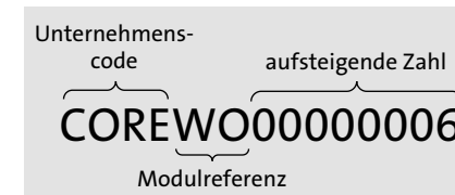
Abbildung 2.1 System-ID, bestehend aus Unternehmenscode, Modulreferenz und fortlaufender Nummer
