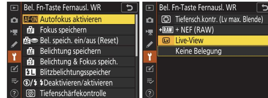
Abbildung 7.16 Im System-Menü legen Sie die Funktion der Fn-Taste des WR-T10 fest.
