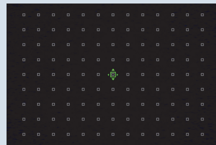
Abbildung 4.12 Durch Drehen des hinteren Einstellrades vergrößern oder verkleinern Sie diesen Fokusrahmen, hier bis auf den Einzelpunkt.
