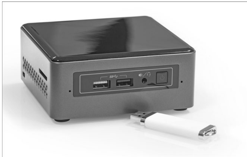
Abbildung 1.2 Ein vollwertiger Computer in einem sehr kompakten Gehäuse: der Intel NUC
