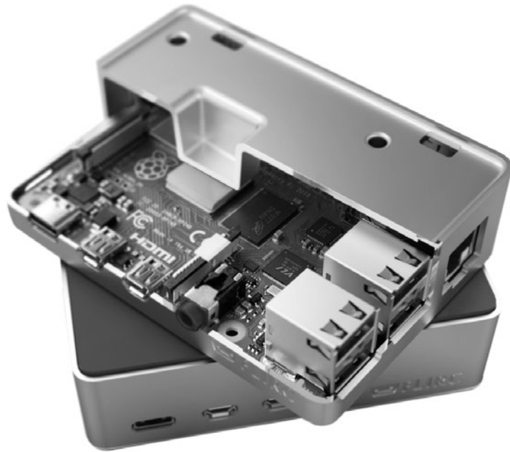
Abbildung 1.7 Beim »FLIRC-Case« dient das ganze Gehäuse als Kühlkörper. Somit ist ein lautloser Betrieb des Servers möglich.
