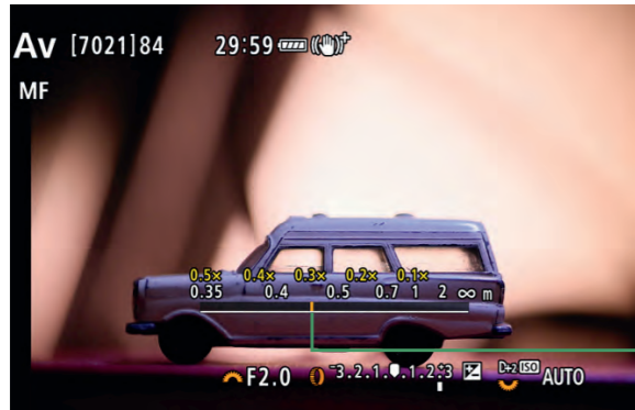
Abbildung 2.42 Das RF 85 mm f2 Macro IS STM ist hier auf eine Entfernung von gut 0,45 m eingestellt, wie der kleine orangefarbene Strich 1 in der Entfernungsskala anzeigt. Darüber wird in Gelb der Abbildungsmaßstab angezeigt, hier 0,3-fach.
