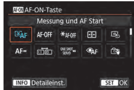
Abbildung 2.30 Der AF muss dann auf der AF-ON-Taste bleiben – Sie könnten ansonsten die EOS R5 so konfigurieren, dass sie gar keinen AF mehr unterstützt.
