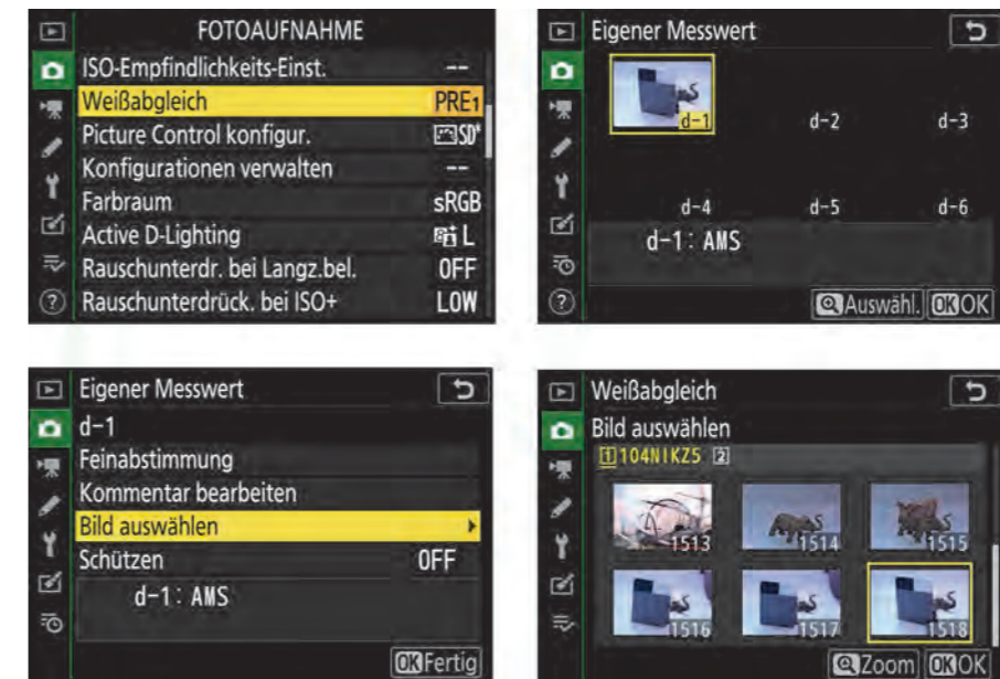
Abbildung 4.23 Mit der Option PRE Eigener Messwert legen Sie einen eigenen festen Weißabgleich an. Haben Sie schon ein Referenzbild aufgenommen, nutzen Sie die Funktion Bild auswählen , um es zu laden.
