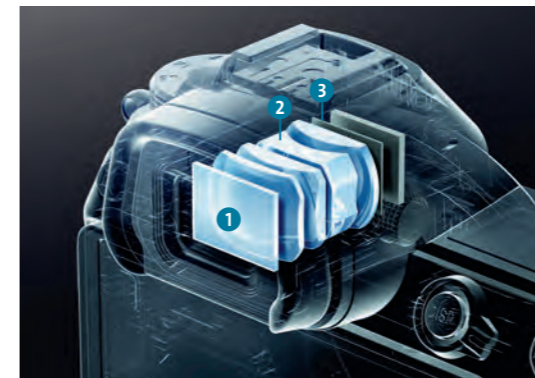
Abbildung 4.1 Der elektronische Sucher der Nikon Z 5: Okularschutzscheibe ①, optisches System ② und Quad-VGA Organic LED Panel ③ (3.690.000 Bildpunkte; Bild Nikon)
