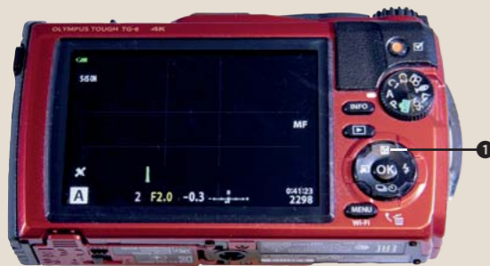
⤴ Belichtungskorrektur an einer Kompaktkamera. Nach Druck auf die +/--Taste kann die Belichtungskorrektur über das Einstellrad an der Gehäuseoberseite eingestellt werden.
