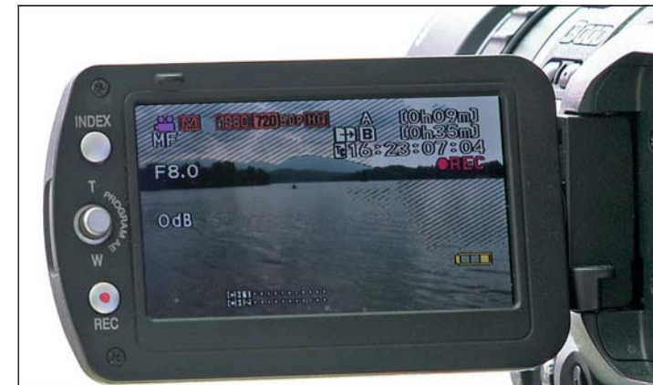
◀ Abbildung 10.17 Belichtungswarnung Zebra auf dem Display eines Camcorders. Hier warnt das Zebra (100%) vor dem überbelichteten Himmel.
