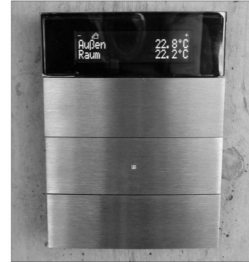
Abbildung 2.5 Alles in einem: Beleuchtung, Jalousien, Raumtemperaturregelung und Szenensteuerung
