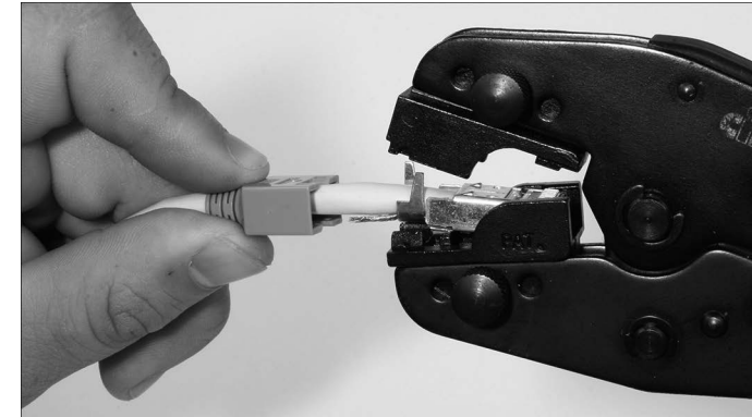
Abbildung 2.23 Einführen des RJ45-Steckers in das Crimpwerkzeug
