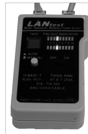
Abbildung 2.26 Prüfung der Patchkabel
