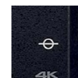
Symbol auf dem Kameragehäuse, das die Lage des Kamerasensors angibt (Bild: Sony)
