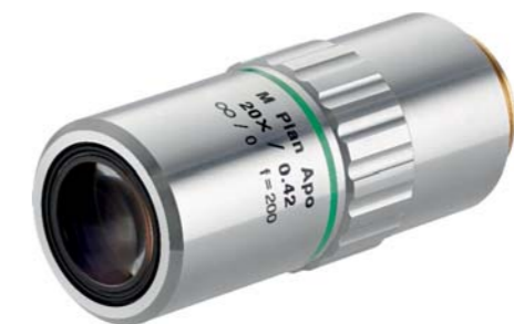
Ein 20-fach vergrößerndes Objektiv mit der numerischen Apertur von 0.42 und keiner Deckglaskorrektur. Das Zeichen ∞ bedeutet, dass es sich um ein unendlich korrigiertes Objektiv handelt. (Bild: Novoflex)
