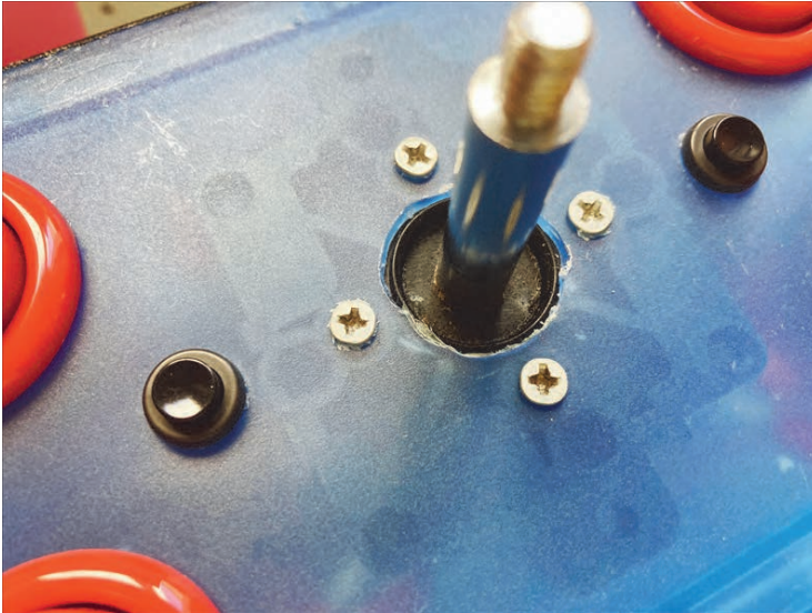
Abbildung 5.22 Wenn du alle Löcher gebohrt hast, kannst du den Joystick festschrauben.
