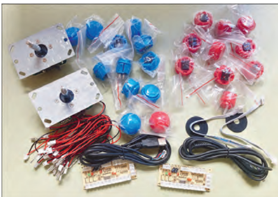
Abbildung 5.17 »Arcade DIY Sets« enthalten alles, was man für den Bau eines (bzw. in diesem Fall von zwei) Joysticks benötigt.
