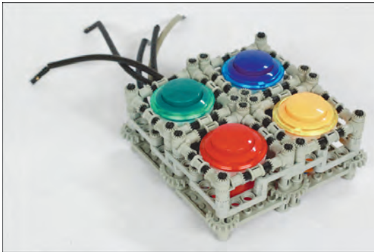
Abbildung 5.16 Vier Knöpfe in einem Gehäuse aus LEGO Technic – die Kabel lassen sich an den GPIO-Port anschließen. Die Ground-Anschlüsse (also jeweils eines der beiden Anschlusskabel) beliebig vieler Knöpfe lassen sich übrigens zusammenlöten, um Kabel zu sparen.
