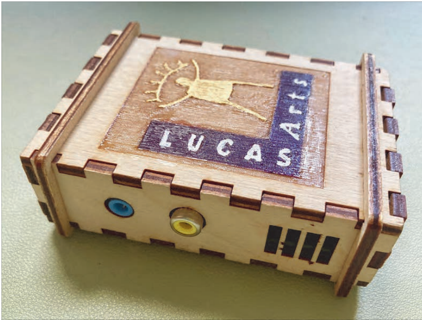
Abbildung 5.4 Ein Raspberry Pi-Gehäuse aus Holz, hergestellt mit einem Lasercutter und anschließend angemalt
