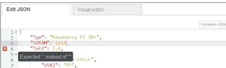
Abbildung 3.7 Der JSON-Editor zeigt einen Fehler an.
