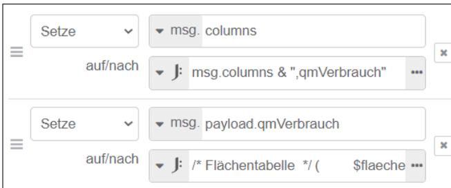
Abbildung 3.39 Der *change*-Node berechnet den Verbrauch pro Quadratmeter.
