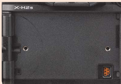
Abbildung 1.7 Schraubgewinde und freigelegte Kontakt-abdeckung zum Anbringen eines Kühlmoduls
