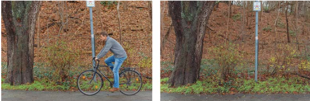
Abbildung 2.46 Durch den Rolling-Shutter-Effekt, hier gezeigt für die X-H2, wurde die Stange des Schildes bei Mitziehen von rechts nach links mit dem Radfahrer unnatürlich verbogen abgebildet (links). Die statische Aufnahme im Vergleich zeigt, dass die Stange eigentlich geradesteht.
