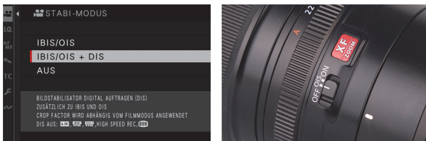
Abbildung 9.7 Links: Im Kameramenü Film-Einstellung > Stabi-Modus finden Sie mehrere Optionen vor. Der Eintrag Aus zum Deaktivieren von IBIS steht nur bei angeschlossenen Objektiven ohne einen OIS-Schalter zur Verfügung. Rechts: Bei Objektiven mit einem OIS-Schalter können Sie den IBIS und OIS jederzeit und ausschließlich über diesen Schalter ein- und ausschalten.
