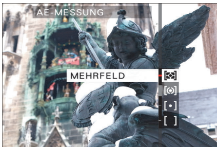
Abbildung 2.5 Die Belichtungsmessmethode Mehrfeld ist für die Programmautomatik in der Regel die beste Wahl.
