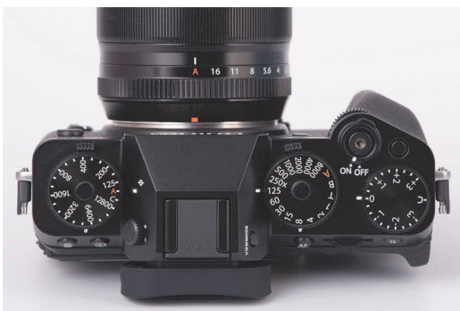
Abbildung 2.11 Die Blende auf A und das Einstellrad für die Belichtungszeit auf einen anderen Wert als A gestellt, wird von der Fujifilm X-T5 als Zeitvorwahl interpretiert, wie Sie am S links unten im Sucher oder auf dem Display erkennen.
