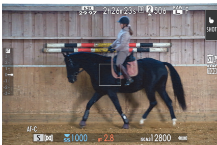
Abbildung 2.13 Der rote Blendenwert (hier: F2.8 ) weist darauf hin, dass zur eingestellten Belichtungszeit 1/1000 s kein passender Blendenwert für eine ausgewogene Belichtung mehr ermittelt werden konnte.
