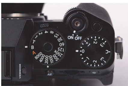
Abbildung 8.57 Links: Die Kamera befindet sich im Bulb-Modus. Rechts: Im Modus »Bulb« wird die Dauer der Belichtungszeit hochgezählt.
