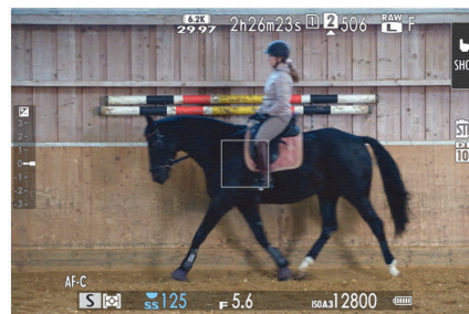
Abbildung 2.11 Die Blende auf A und das Einstellrad für die Belichtungszeit auf einen anderen Wert als A gestellt, wird von der Fujifilm X-T5 als Zeitvorwahl interpretiert, wie Sie am S links unten im Sucher oder auf dem Display erkennen.
