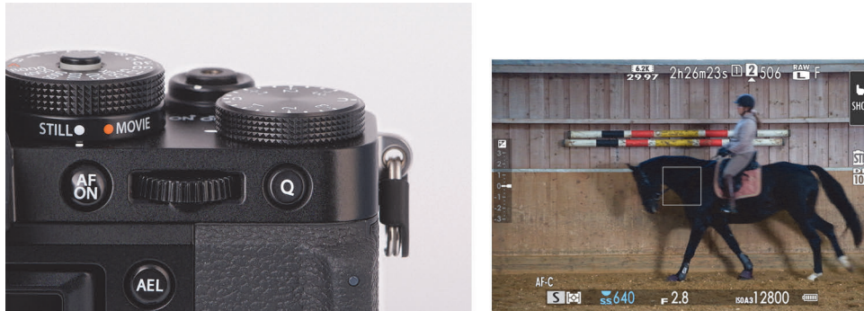
Abbildung 2.14 Mit dem hinteren Einstellrad stellen Sie die Drittelseiten zwischen den ganzen Schritten ein (hier: 1/640 s), die mit dem Einstellrad für die Belichtungszeit eingestellt werden können.
