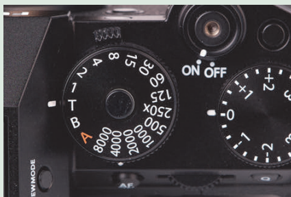
Abbildung 2.15 Stellen Sie das Einstellrad auf T, können Sie alle Belichtungszeiten inklusive der Drittelseiten über das hintere Einstellrad einstellen.
