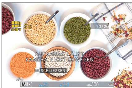
Abbildung 8.53 Eine Fortschrittsanzeige zeigt an, wie viele Pixel-Shift-Aufnahmen bereits gemacht wurden bzw. insgesamt erstellt wurden.
