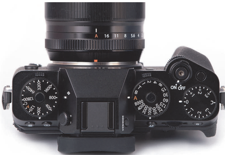
Abbildung 2.1 Die Programmautomatik aktivieren Sie, indem Sie das Einstellrad für die Belichtung und die Blende (am Objektiv) auf das rote A stellen. Beim ISO-Wert habe ich mich hier für ISO 800 entschieden.
