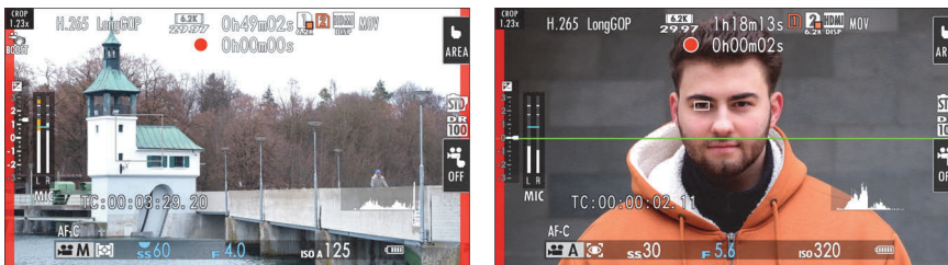
Abbildung 9.4 Mit Vario AF legen Sie fest, wo der Fokus beim Filmen liegt. Auch die Gesichtserkennung zusammen mit AF-C ist eine gute Möglichkeit, beim Filmen zu fokussieren.
