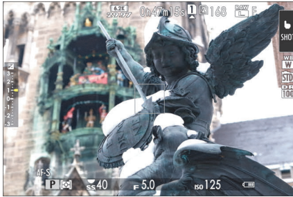
Abbildung 2.4 Am Buchstaben P unten links erkennen Sie, dass Sie die Programmautomatik eingestellt haben. Die beiden anderen Werte – Belichtungszeit ( SS ; hier 40 ) und Blende ( F ; hier 5.0 ) – werden in diesem Modus automatisch angepasst.
