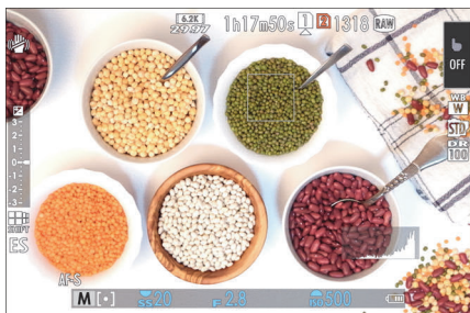
Abbildung 8.52 Das Shift -Zeichen unter der Belichtungs-skala zeigt an, dass beim Betätigen des Auslösers Pixel-Shift-Aufnahmen erstellt werden.
