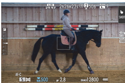
Abbildung 2.12 Hier habe ich das Einstellrad für die Belichtung auf 500 gestellt, womit eine Belichtungszeit von 1/500 s verwendet wird. Im Sucher oder Display wird der Wert blau mit SS 500 angezeigt.
