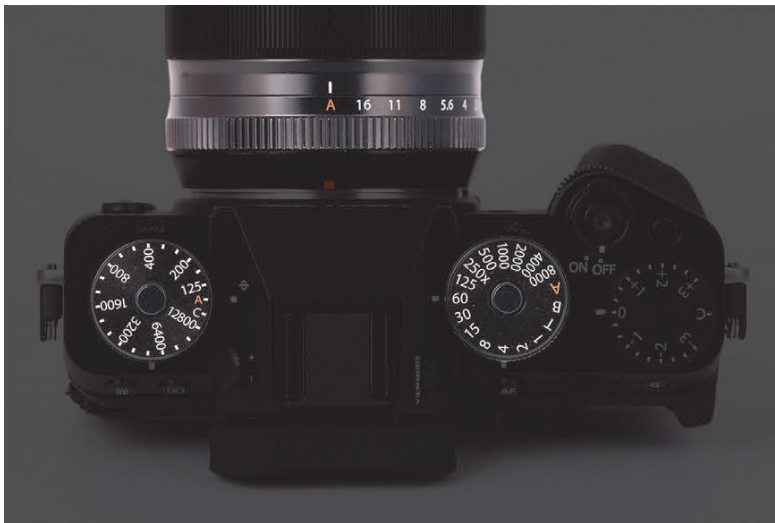
Abbildung 1.7 Die nötigen Einstellungen für die verschiedenen Aufnahmeprogramme (linkes Rad: ISO-Wert, rechtes Rad: Belichtungszeit, am Objektiv: Blende)
