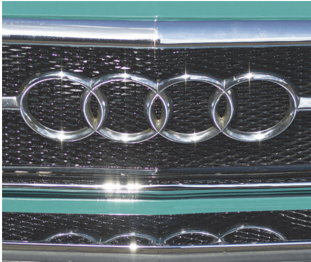
Abbildung 3.3 Dass die Sonnenreflexe hier nach oben und unten auslaufen, liegt an der Beugung am Schlitzverschluss. 50 mm | f2,2 | 1/8000 s | ISO 200
