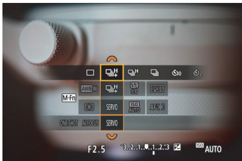
Abbildung 1.6 Über die M-Fn-Taste können Sie acht (bzw. nach Konfiguration neun) Einstellungen in einer Ansicht verändern: Weißabgleich, Betriebsart, Blitzbelichtungs-korrektur und Bildstil mit dem Hauptwahlrad, Belichtungsmessmethode, AF-Betrieb, ISO und AF-Bereich mit dem Schnellwahlrad.
