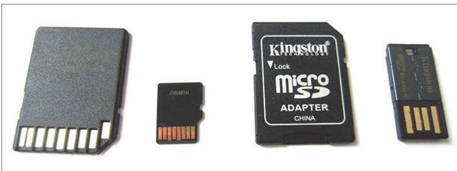
Abbildung 1.8 Eine SD-Karte in Standardgröße, eine Micro-SD-Karte, ein SD-Karten-Adapter sowie ein winziger USB-Adapter (ohne Kabel) für Micro-SD-Karten
