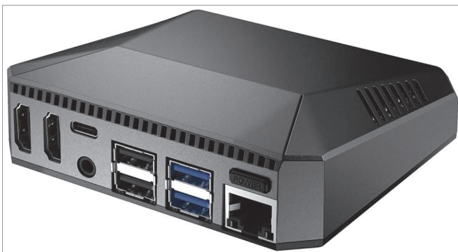
Abbildung 11.12 Das Argon One verlegt die Anschlüsse, dank interner Verkabelung und Elektronik.
