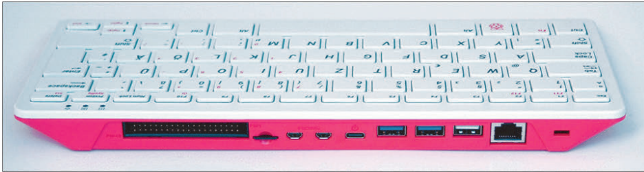
Abbildung 1.5 Die Rückseite mit den Schnittstellen des Raspberry Pi 400 – von links nach rechts: GPIO, SD-Karte, 2 × Micro-HDMI, USB-C, 2 × USB 3.0, USB 2.0 (Maus), Ethernet
