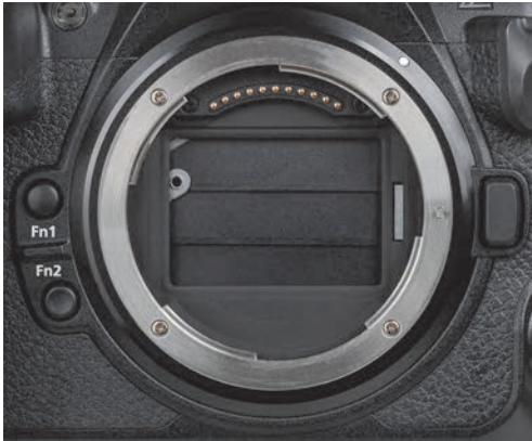
Abbildung 1.3 Der Sensorschutz verringert das Eindringen von Staub beim Objektivwechsel. Achten Sie darauf, die feinen Lamellen nicht zu berühren, um sie nicht zu beschädigen.
