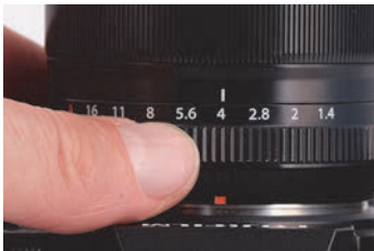
Abbildung 2.15 Blendenwerte bei Objektiven mit durchgehender Lichtstärke und Festbrennweiten können Sie direkt einstellen, im Beispiel auf f4 .
