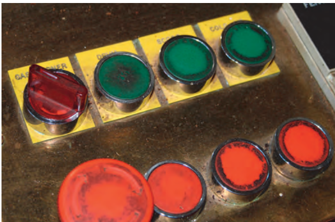
Abbildung 2.3 Rot heißt Stopp oder rückwärts, Grün heißt Start oder vorwärts. Wer diese Konvention verletzt, riskiert Fehlbedienungen.
