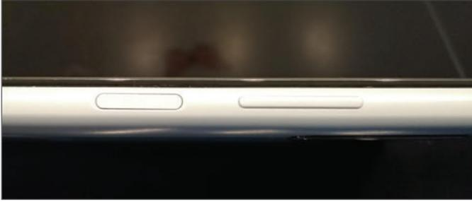
**Abbildung 1.13:** Die einzelne Powertaste und die lange Lautstärkentaste.
